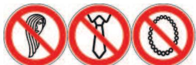
Los objetos sueltos pueden engancharse a las partes móviles de la máquina y causar serios daños.
