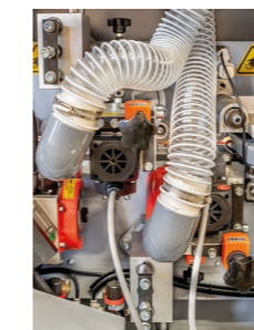
Doppelfräsggregat bringt die Ober- und Unterseite in Form / double milling unit bring the top and bottom edges into shape
